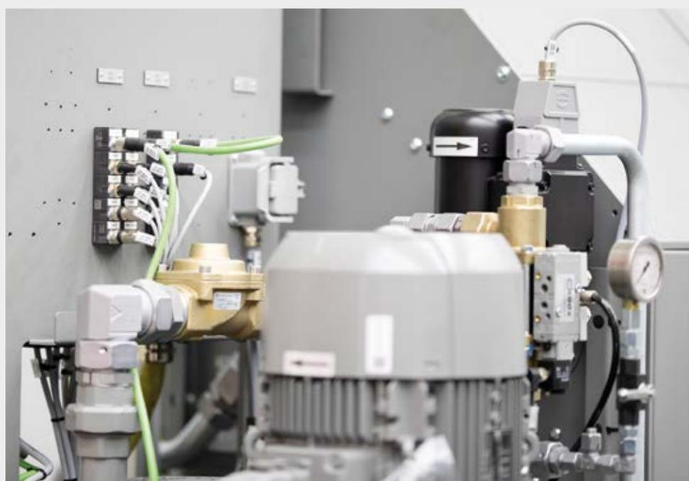
Le module Cube67 monté sur un centre d'usinage de Hermle.
